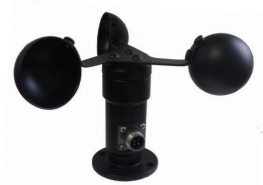
传感器壳体和风杯采用铝合金材料，使用特种模具精密压铸工艺，尺寸公差甚小表面精度甚高，内部电路均经过防护处理，整个传感器具有很高的强度、耐候性、防腐蚀和防水性。电缆接插件为军工插头，具有良好的防腐、防侵蚀性能，能够保证仪器长期使用，同时配合使用风速传感器内部进口轴承系统说明书，确保了风速采集的精确性。
