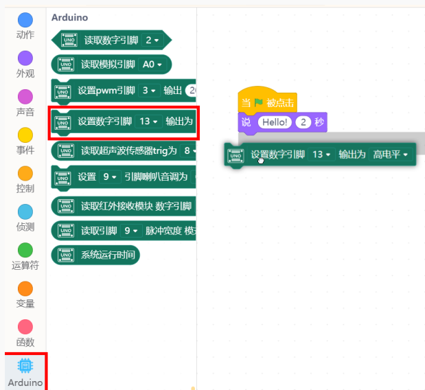
图 C-15 设置数字引脚输出
