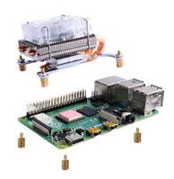
● 用 M2.5 螺丝将亚克力保护板固定在树莓派上。
