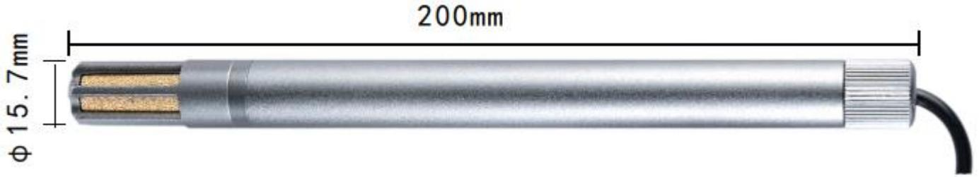
模块测量范围广，支持 $-40\sim 120^{\circ}\text{C}$ 的温度检测和 $0\sim 99.9\% \text{RH}$ 的湿度检测，检测精度高，响应速度快。铝合金外壳全包裹，防水耐高温，在较恶劣环境也能正常使用；探头采用透气防尘设计，有效保护内部线路板，延长使用寿命。
